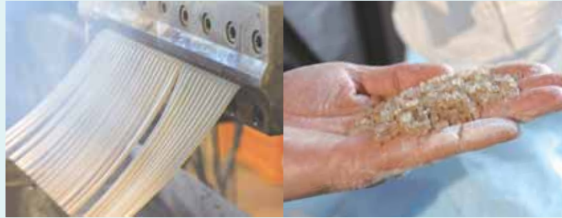
溶かされたトレーが、スパゲティのように 押し出され、コンベアの上に伸びていく。
