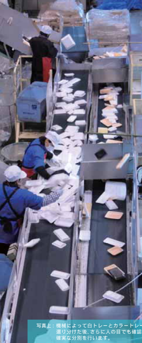
写真下：リサイクルできるトレーだけが、 コンベアに乗って洗浄機の中へと運ばれる。
