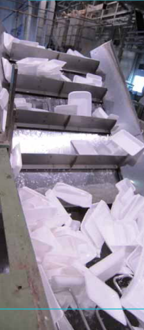
写真下：リサイクルできるトレーだけが、 コンベアに乗って洗浄機の中へと運ばれる。
