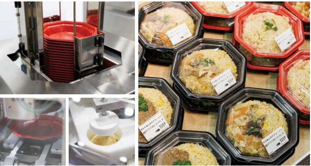
自動容器供給機や自動飯盛り機に適応する多種多様な サイズと形状の容器を随時開発し省人化に対応
