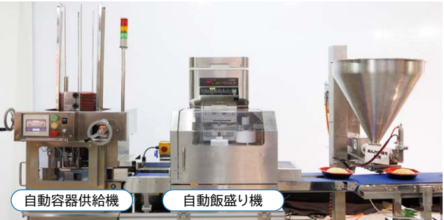
自動容器供給機や自動飯盛り機に適応する多種多様な サイズと形状の容器を随時開発し省人化に対応
